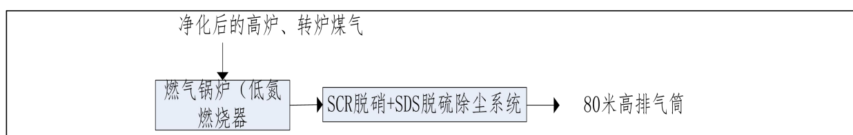
图 4-2 废气治理示意图
